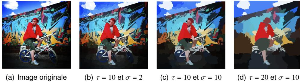
FIGURE 5.7 – Segmentation d’une image couleur de 512×512 pixels par l’implémentation GPU quick-shift de [41].
