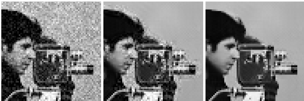
(a) Image bruitée (b) Résultat avec des patches carrés (c) Résultat avec des patches adaptatifs
