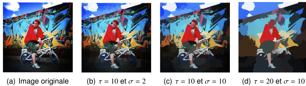
FIGURE 5.7 – Segmentation d’une image couleur de 512×512 pixels par l’implémentation GPU quick-shift de [40].
