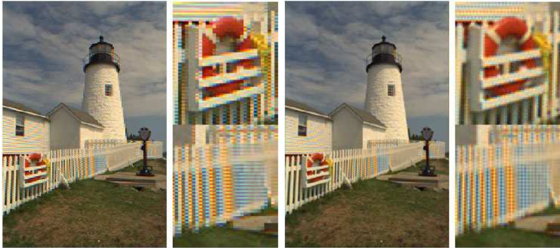
FIGURE 4.7 – Illustration des résultats obtenus avec l'interpolation par copies de pixels à gauche et l'interpolation bilinéaire à droite [2, 3].
