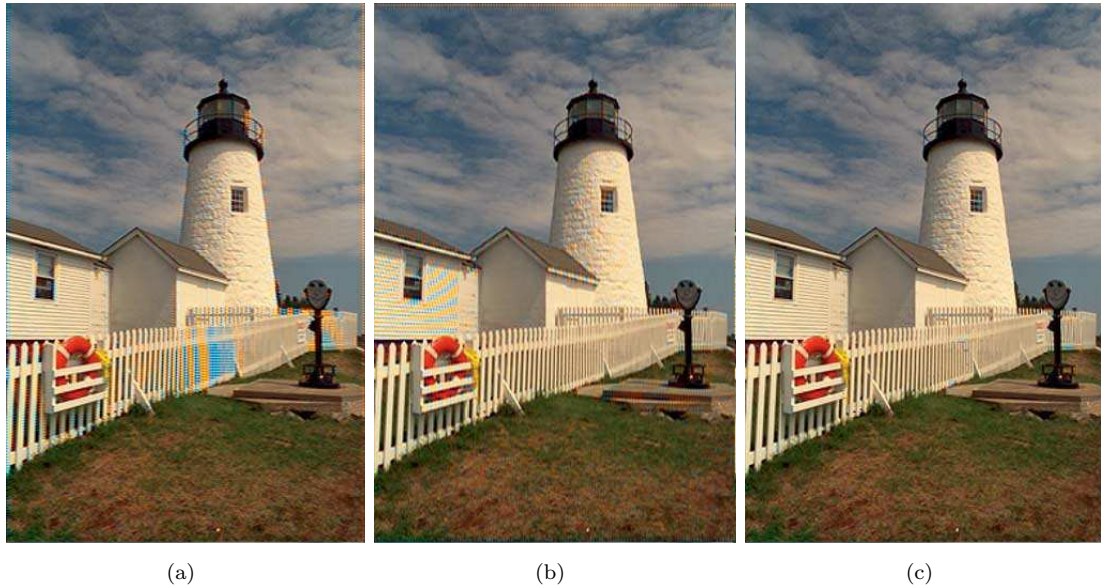
FIGURE 4.12 – Illustration des résultats obtenus avec l'algorithme de dématriçage proposé par Hirakawa et al. dans [7]. (a) image interpolée horizontalement, (b) image interpolée verticalement, (c) image mixée d'interpolation horizontales et verticales dans laquelle la direction d'interpolation est fait en utilisant le critère de Hirakawa [18].
