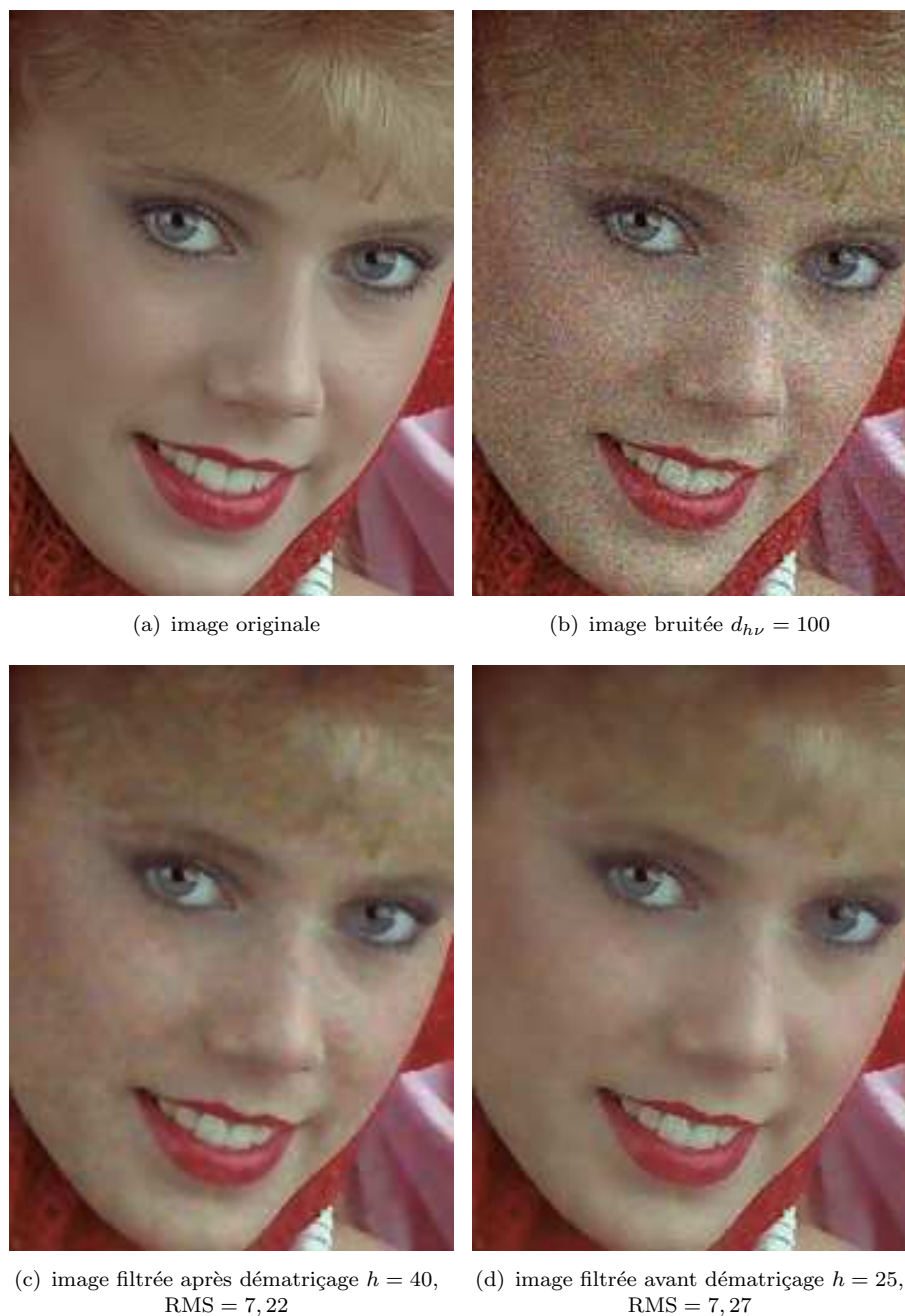
FIGURE 7.15 – Comparaison visuelle entre le filtrage bilatéral appliqué avant et après l'étape de dématricage.
